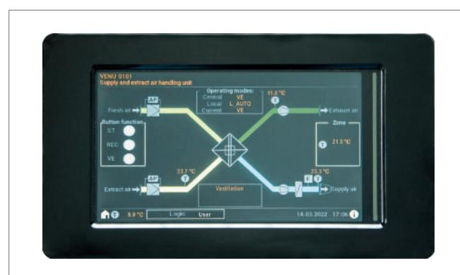
Slika B2: Upravljački terminal sistema C-ST
