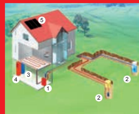
**Toplotna pumpa voda/voda sa podzemnom vodom**
