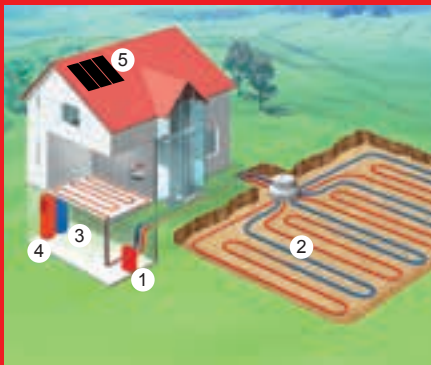
Toplotna pumpa zemlja/voda sa podzemnim kolektorom
