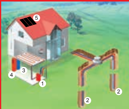
Toplotna pumpa zemlja/voda sa dubinskim sondama
