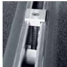
Gornje pričvršćivanje se vrši pomoću steznih elemenata postavljenih između kolektora. Ovi stezni elementi se učvršćuju u gornjoj montažnoj šini tako što se ubace i zakrene, a zatim pritegnu pomoću zavrtnja.
