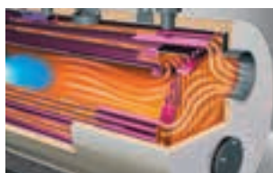
Komora za okretanje dimnih gasova sa zavarenim orebrenim cevima
