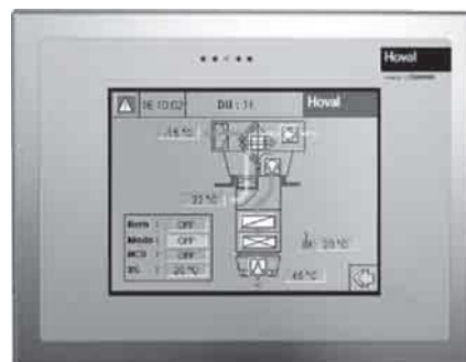
Slika L1: Rad preko „touch panel-a“ sa DigiMaster terminalom
